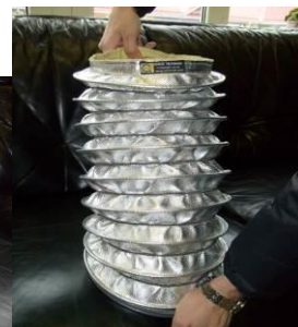
Сильфон для защиты штока гидроцилиндра подъема холодильника МНЛЗ
