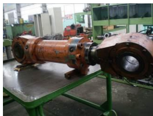
Сильфон для защиты штока гидроцилиндра подъема холодильника МНЛЗ
