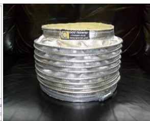
Сильфон для защиты штока гидроцилиндра подъема холодильника МНЛЗ
