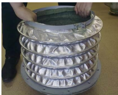
Сильфон для защиты нажимного винта стана PQF
